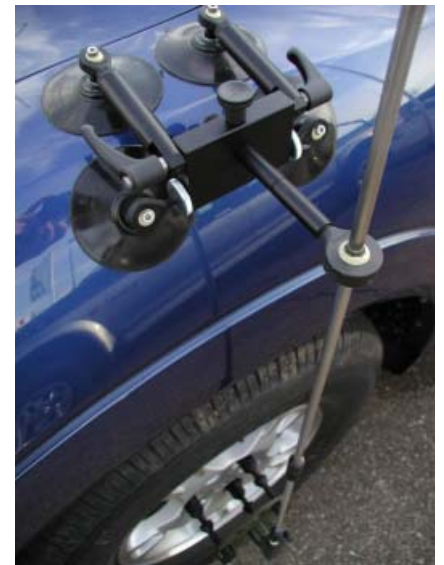
Größerer Abstand durch Verlängerung des Gelenkkopfes
