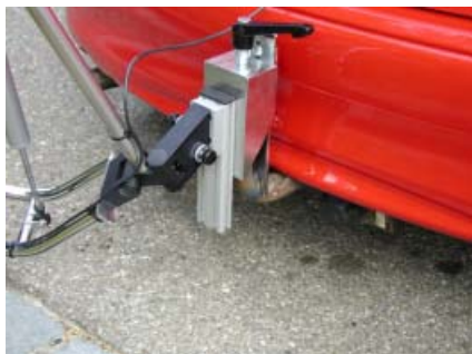
Befestigung an der PKW Anhängekupplung
