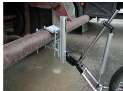
Messradbefestigung am Unterfahrschutz bei LKWs
