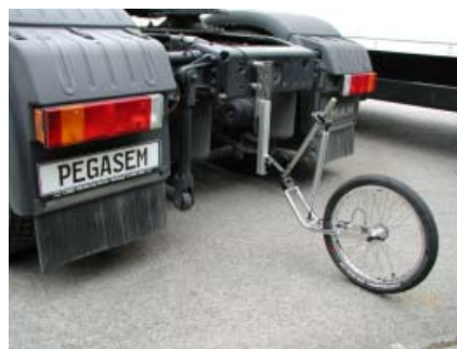
Messradmontage über Flanschadapter am Karosserieträger
